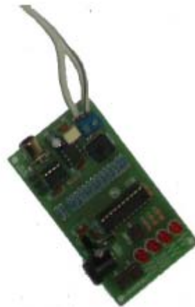
Figure 9 : Dispositif émetteur de son pur sinusoïdal permettant la calibration des enregistreurs.
